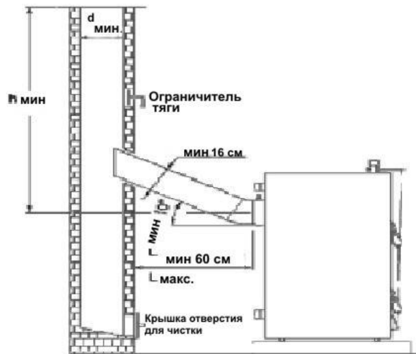
Рис. 6 Пример подключения к дымоходу
