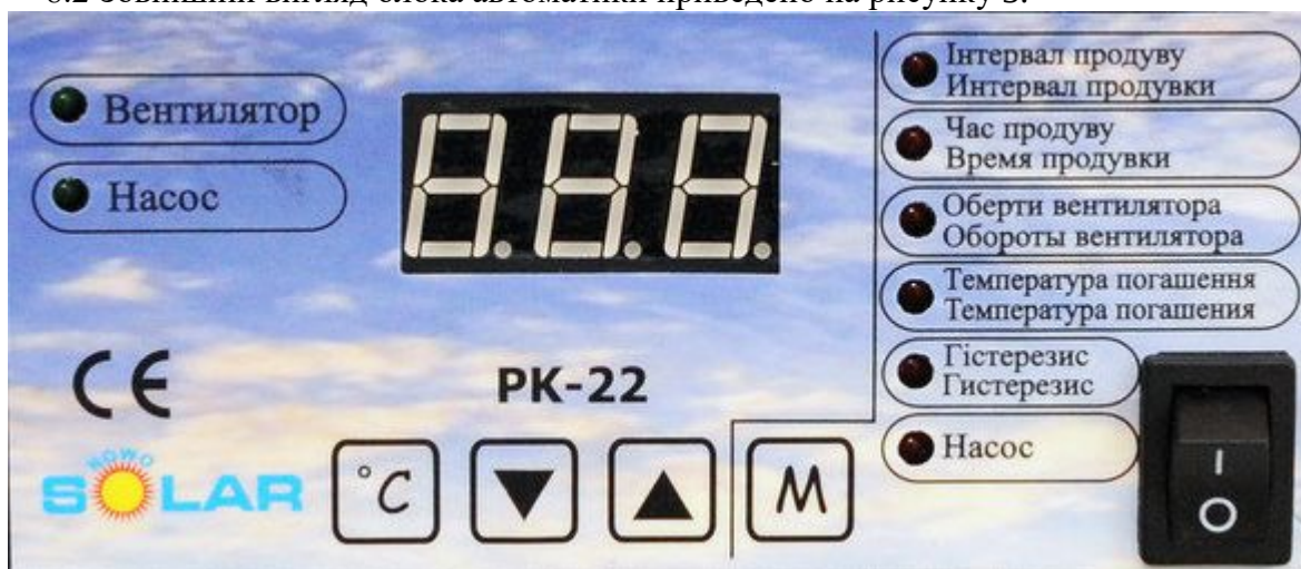
Рисунок 3 – Зовнішній вигляд передньої панелі контролера
